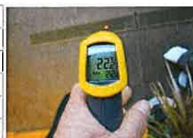
▲OMソーラー吹き出し部の放射温度測定。床タイル面を測定したところ19℃であった。
